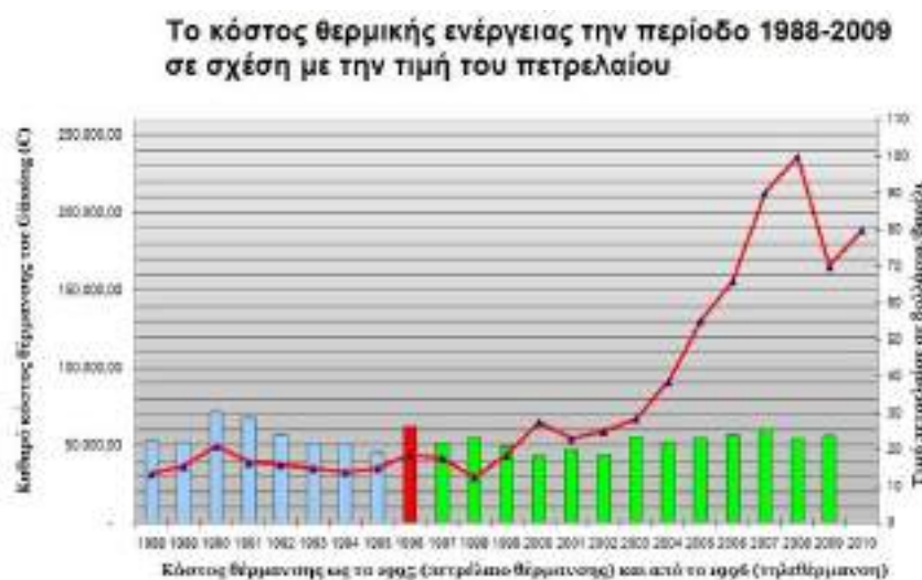
Σχήμα 1.1. Σύγκριση κόστους θερμικής ενέργειας τηλεθέρμανσης με βιομάζα και πετρελαίου για την πόλη του Güssing της Αυστρίας 16
