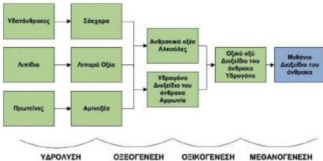
Σχήμα 2.1: Τα κύρια βήματα της διεργασίας της Αναερόβιας Χώνευσης 32
